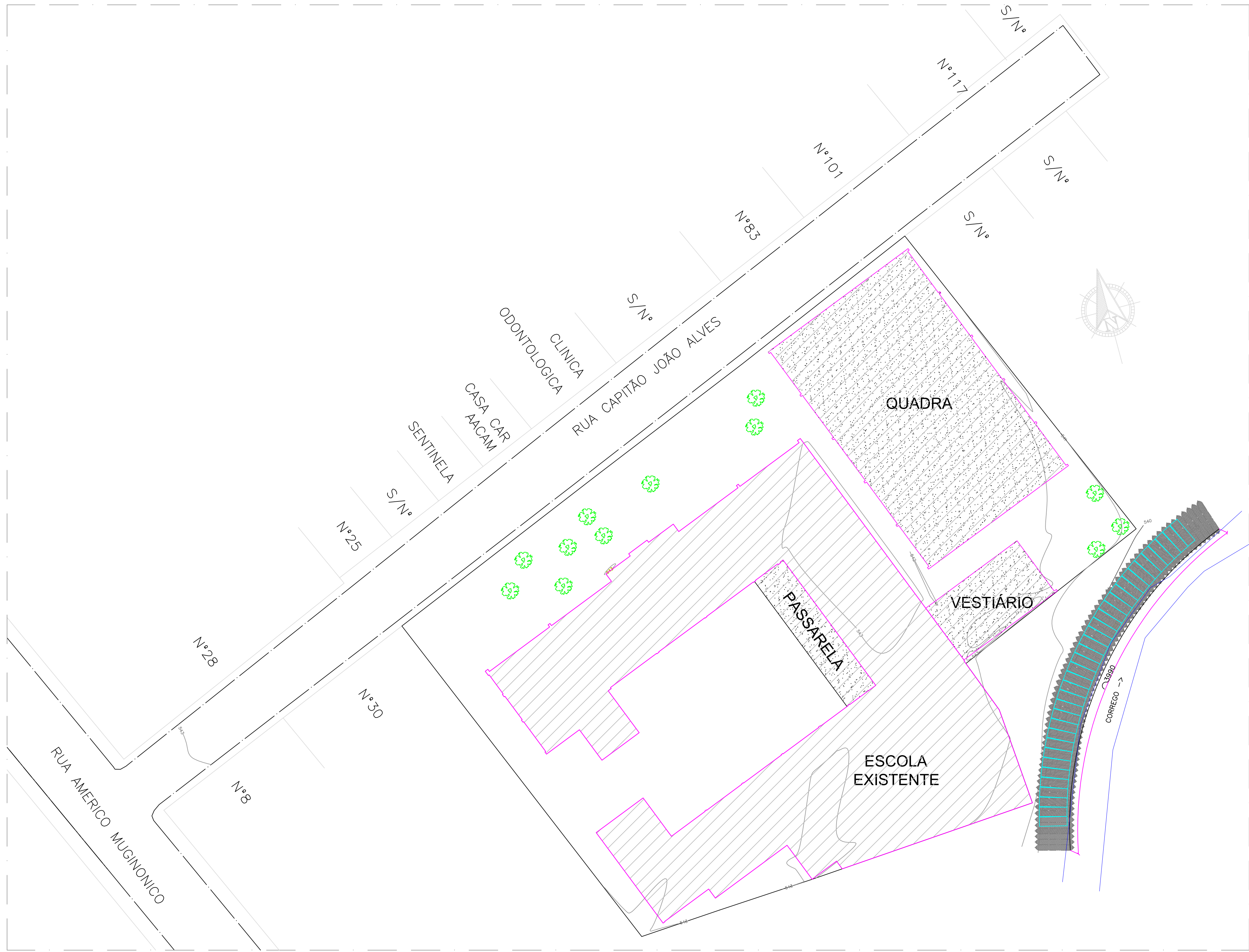
PLANTA DE IMPLANTAÇÃO DO MURO DE CONTENÇÃO GABIÃO ESCALA: 1/250 PROJEÇÃO DO ENROCAMENTO COM GABIÃO SACO
